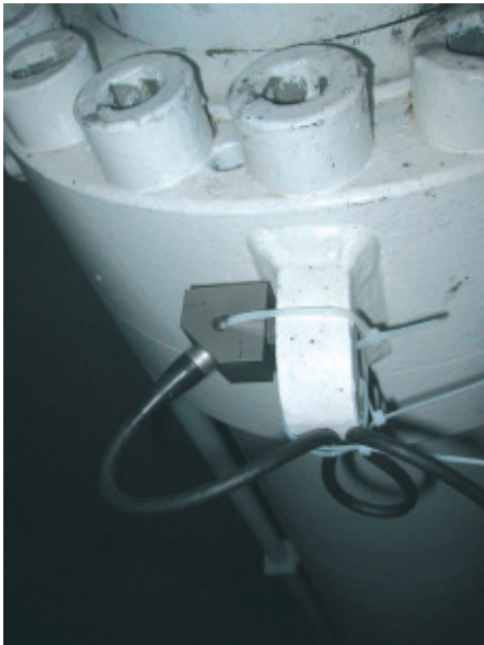
6: Anordnung der Beschleunigungssensoren an Gelenklager (oben) und Zylinderkopf unten)
