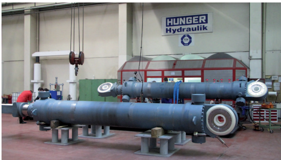
7: Oyster-800-Zylinder auf dem hydraulischen Teststand
