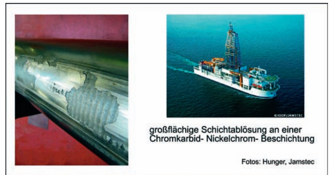
Bild 3: Mechanisches Schichtversagen durch Abplatzen.
