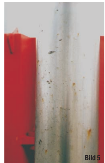
Bild 4: Beispiel für Unterrostung einer Metalloxidbeschichtung. Bild 5: Beispiel einer Pittingbildung an einer Nickel-Chrom-Beschichtung. Bild 6: Beispiel für Spaltkorrosion an einer Metalloxidbeschichtung.
