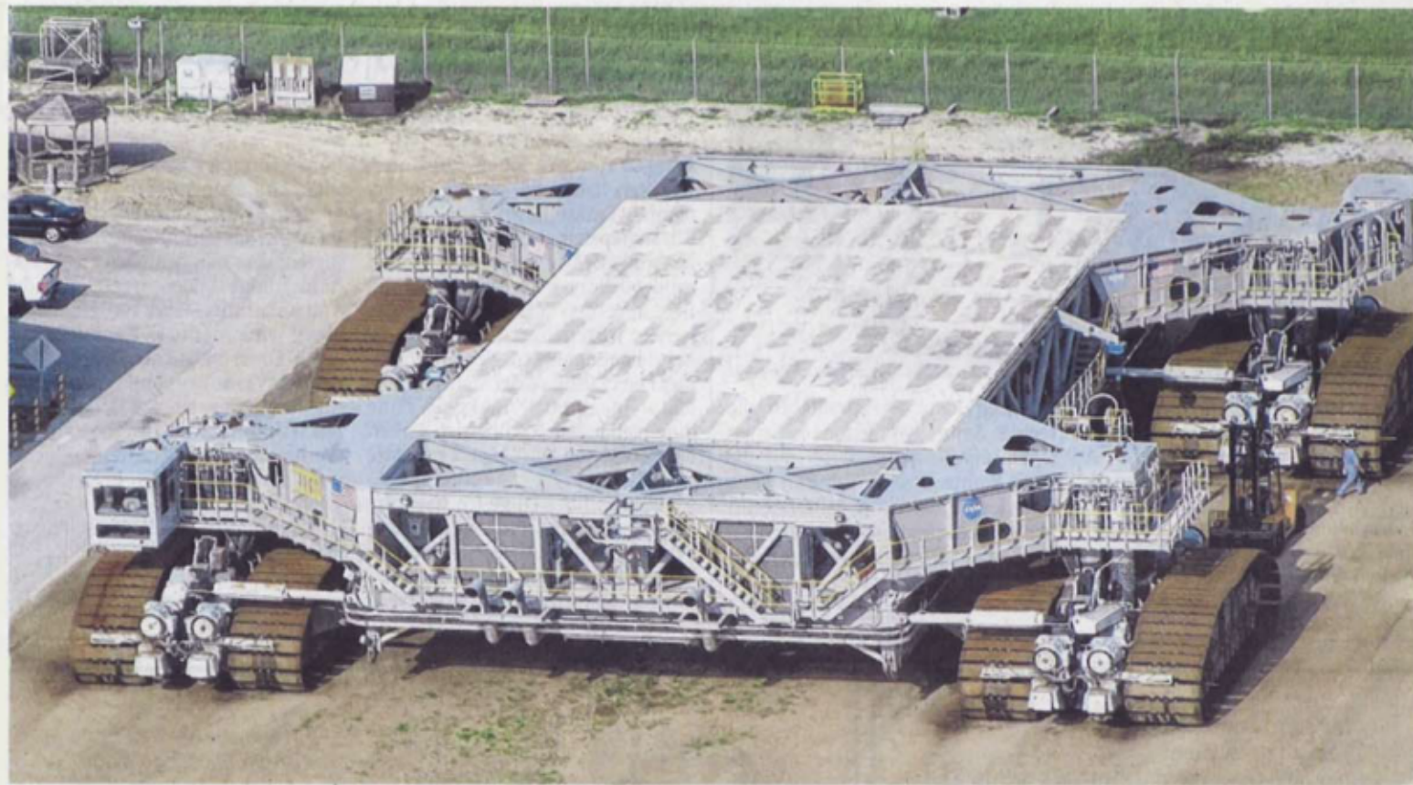
Mehr Leistung durch Hunger-Technik: Der riesige Kettentransporter der Nasa für Raketen und Raumfahrzeuge wird mit Hydraulikzylindern aus Lohr ausgerüstet.
