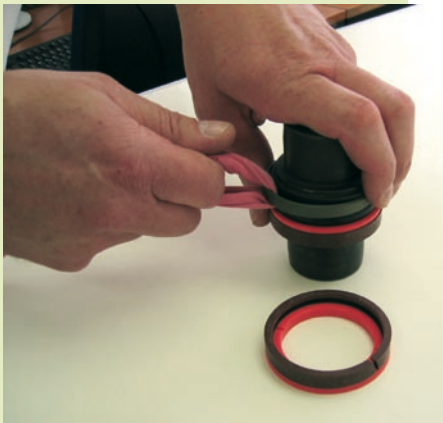
10: Montage eines Gleitringes
