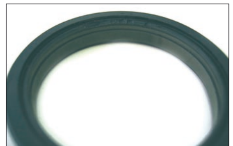
3: Chemisch angegriffener NBR-Ring
