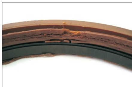
2: Hydrolyse am Stangennutring
