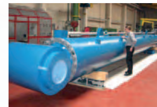
Свайный копер для основания фундамента опор моста или для установки портового сооружения китайского заказчика
