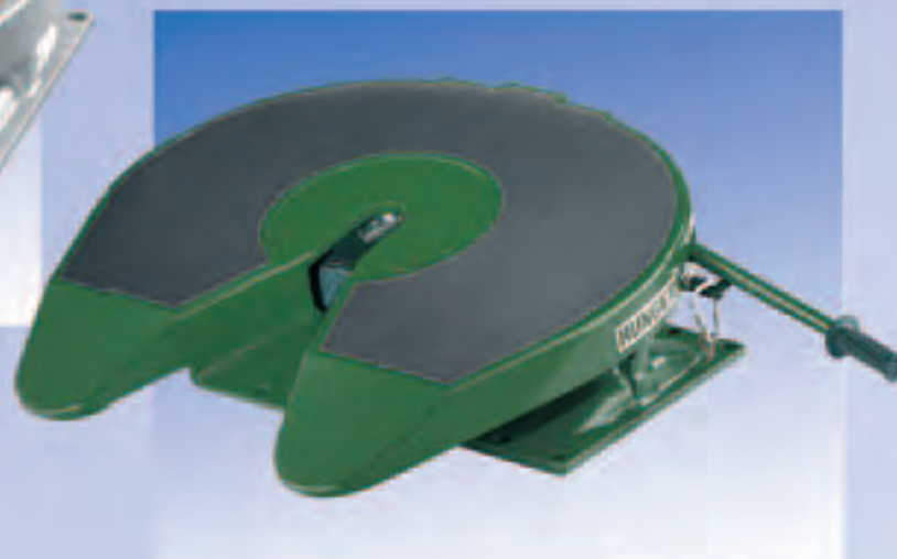
Седельно-сцепное устройство, не требующее ремонта
