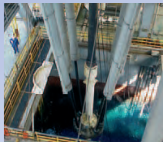
Современный корабль для бурения нефтяных скважин с компенсирующими цилиндрами фирмы Хунгер Гидравлика
