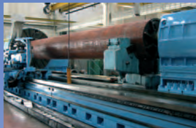
Токарная обработка крупногабаритных деталей диаметром до 4 м и длиной до 25м
