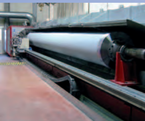
Установка для нанесения покрытий из композиционного материала с оксидами металла Цераплате 2000/Ceraplate 2000
