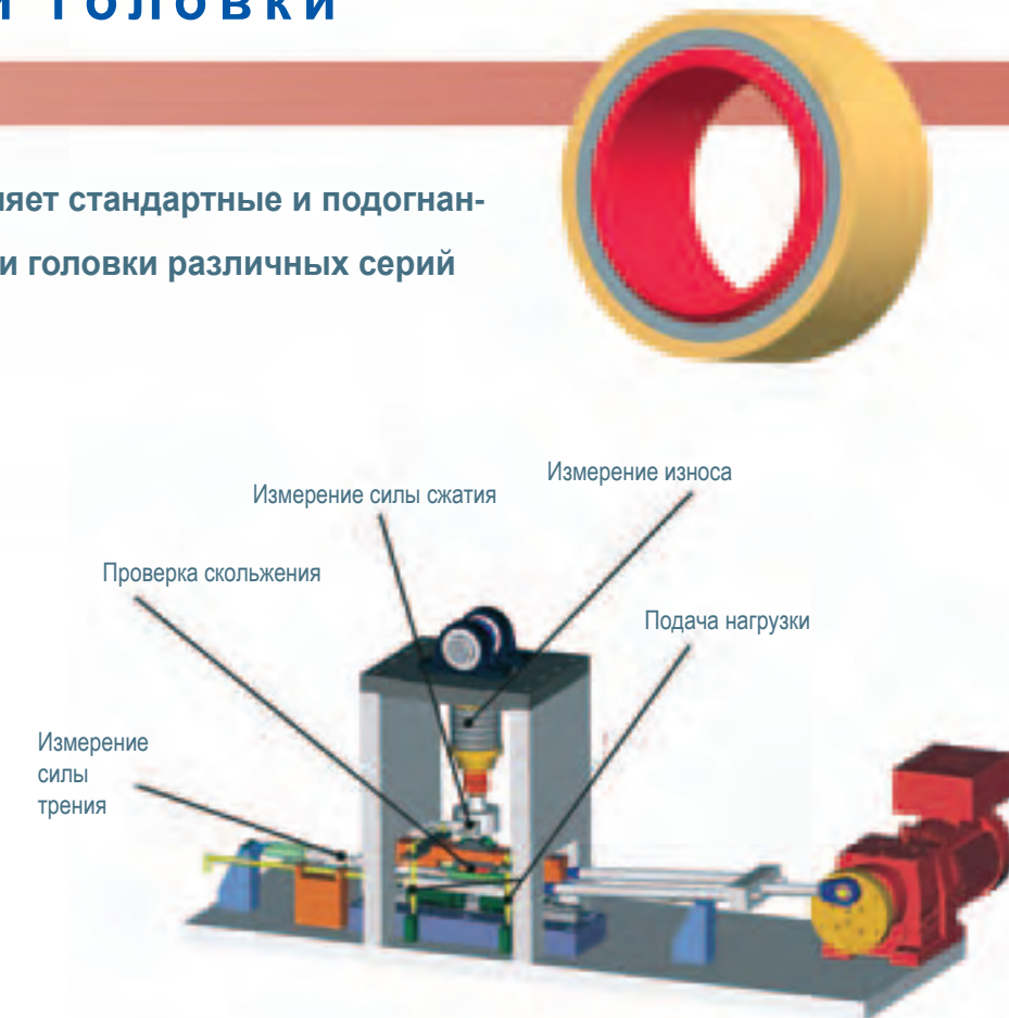
Испытательный стенд для поворотных подшипников - трибометр
