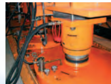
Цилиндр с домкратом подушки подъемника
