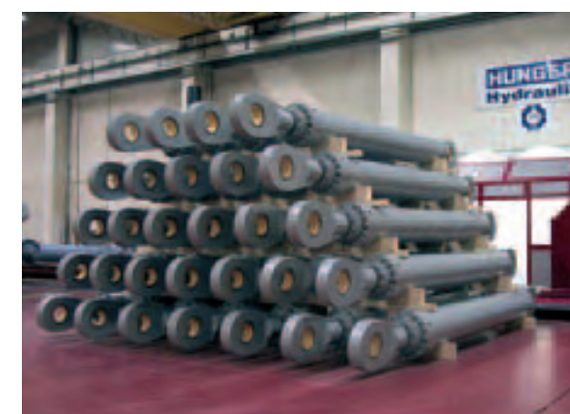
Гидроцилиндры для расположенной в море платформы
