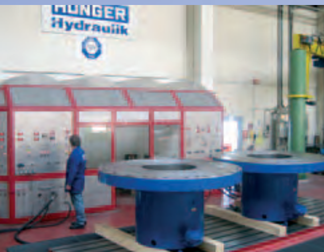
Гидравлический кузнечный пресс с 4 цилиндрами (фотография и эскиз, университет в Штутгарте, институт кузнечного оборудования)
