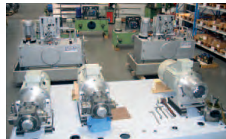
Монтажный цех гидроагрегатов
