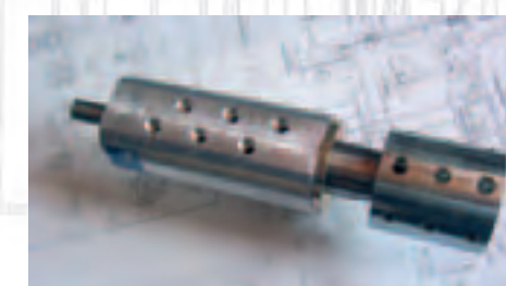
Специальный вращающийся коллектор для резальных и сварочных машин
