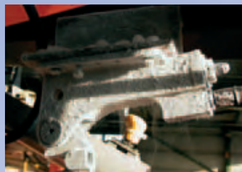
Стопорный крюк для шасси при низкой температуре -54°C
