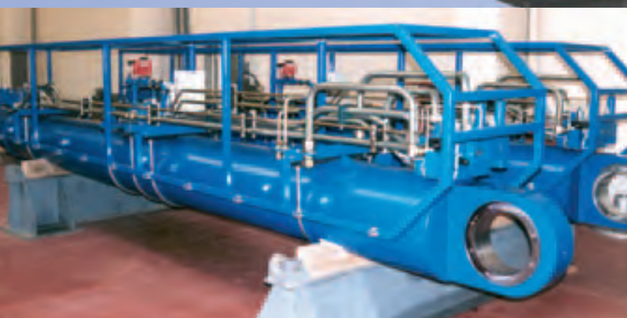
Цилиндр разводного моста с установленными гидравлическими предохранительными и элементами системы управления
